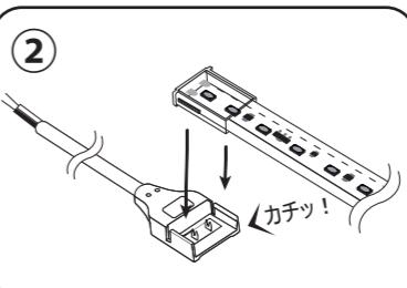
上から横の凹に合わせカチッと音がするまで接続コネクターに押し込む。
