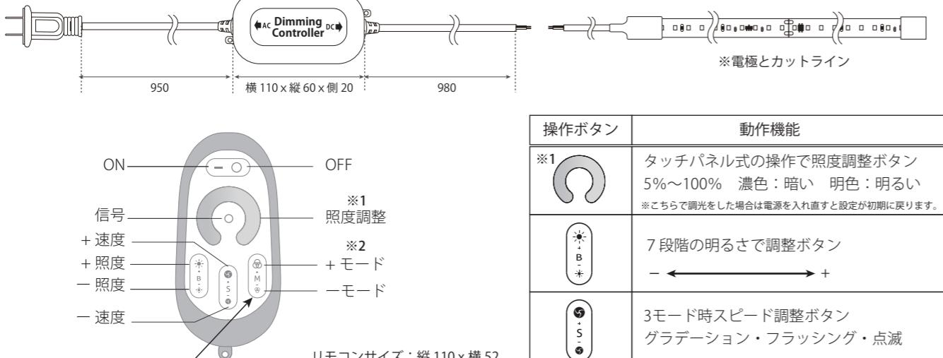
「※1」の照度微調整ボタンで調整した場合は電源を入れ直すと照度が初期設定に戻ってしまいます。お好みの照度状態を保つためには「※2」モードボタンで5段階のお好み照度設定を行って下さい。
